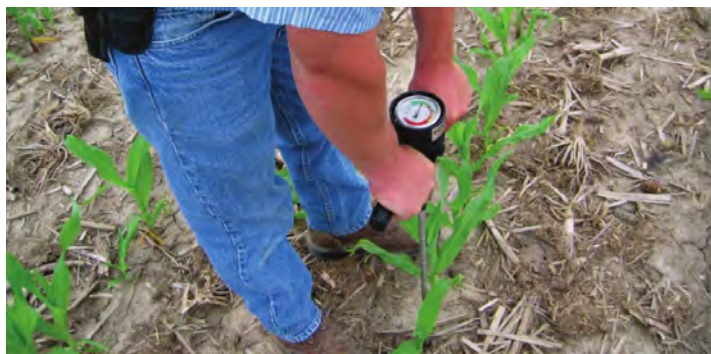
Figura 8. Misurazione del compattamento del suolo con un penetrometro.
