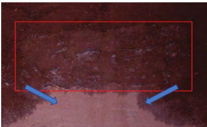
Figura 4. L'acqua, mentre scorre attraverso la struttura del suolo, viene rallentata da uno strato di terreno altamente compattato (delimitato dal rettangolo rosso). L'acqua scorre attraverso il terreno meno compattato più rapidamente e infine raggiunge gli strati al di sotto della zona ad elevato compattamento (Strachan e Jeschke 2017).
